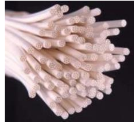
Ansicht der UF-Membranen
